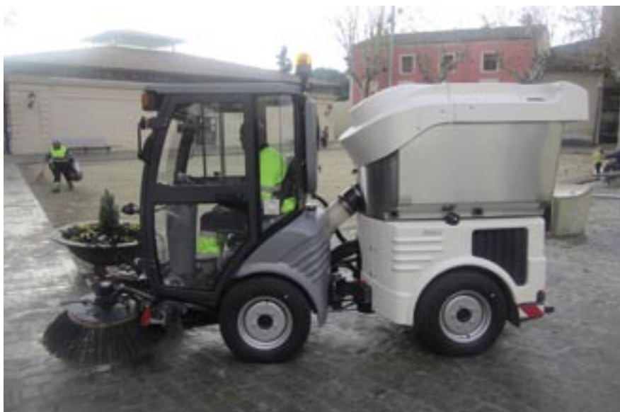
La nova màquina articulada permet netejar de forma mecànica voreres i calçades.
